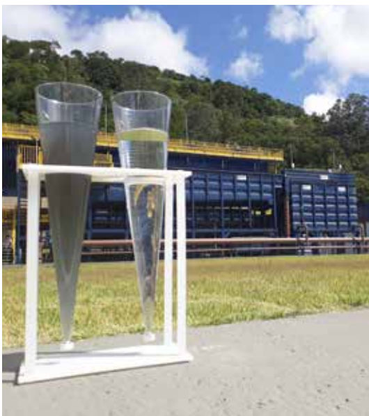
Esgoto Bruto e Tratado na ETE Figueira
